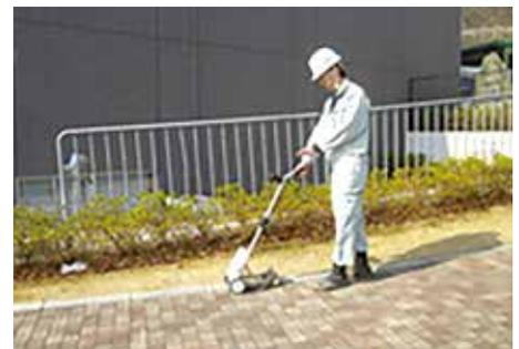
カート式ガス検知器による
