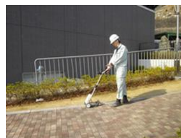
地中のガス管をカート式ガス検知器を使って、異常がないかを調査します
